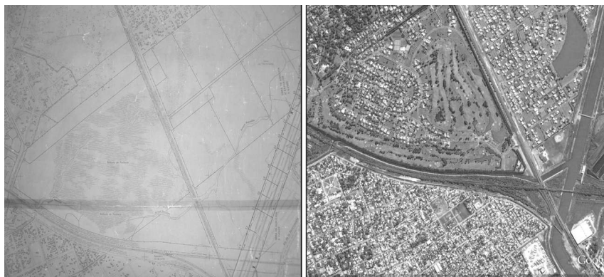
Figura 1.6 – Modificación de la traza del arroyo Basualdo (antes y después de las obras de la UNIREC). Fuente: Plano de Sistematización de la cuenca media e inferior del río Reconquista. Primera etapa, Dirección de Hidráulica, MOSP, 1986. Fuente: Imagen Google Earth, 26/12/2008, Spot 5, Lat/long (centre): -34.4013/-58.4357.
