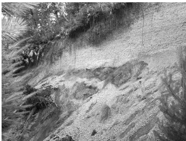
Figura 14.3 – Depósito de material piroclástico donde se puede observar la inestabilidad de los materiales. Fuente: fotografía tomada por los autores.
