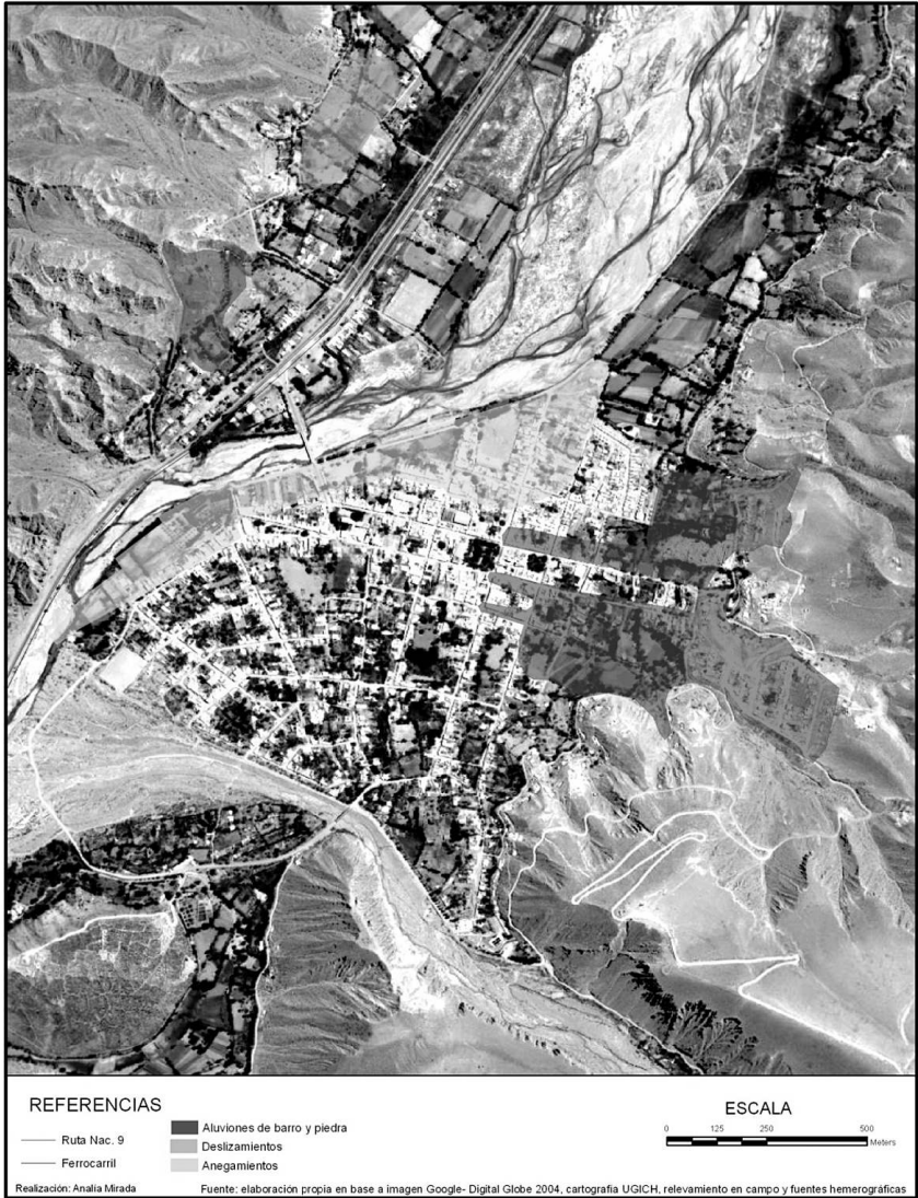
Figura 7.3 – Localidad de Tilcara. Áreas impactadas según tipo de fenómeno (2001-2009). Fuente: Google Digital Globe 2004, cartografía UGICH, relevamiento en campo y fuentes hemerográficas.
